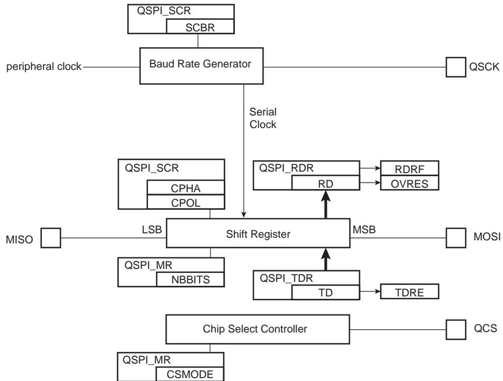
**42.6.4.3 SPI Mode Flow Diagram**
