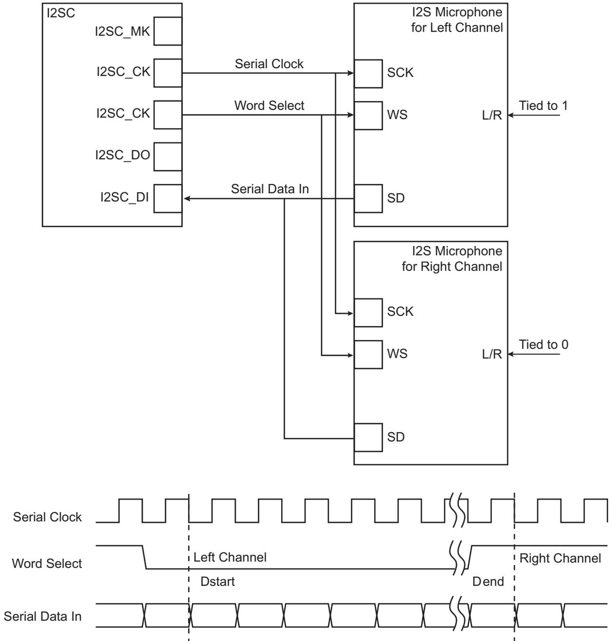
**Figure 45-7. Codec Application Block Diagram**
