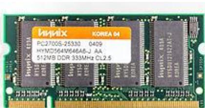
A 512MB [DDR](#) 333 MHz SO-DIMM Hynix memory module
