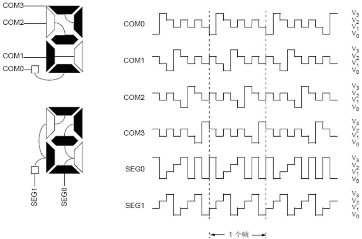
V<sub>3</sub>=VDD (VDD 为 LCD 供电电压)
