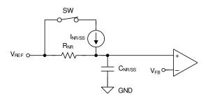
Figure 27. Simplified Soft-Start Circuit
