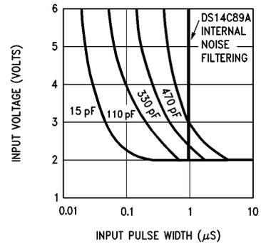
**FIGURE 7. Noise Rejection vs Capacitance for DS1489A**
