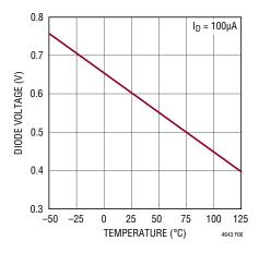
Figure 6. Diode Voltage V<sub>D</sub> vs Temperature T(°C)
