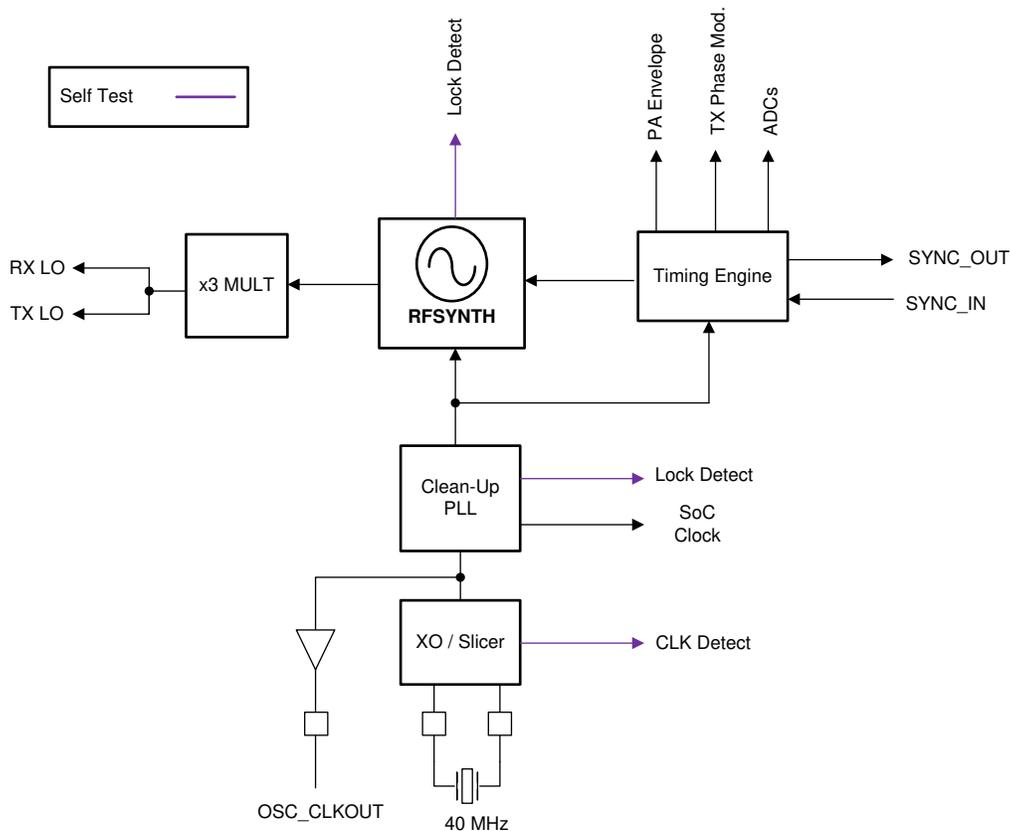
**Figure 8-2. Clock Subsystem**
