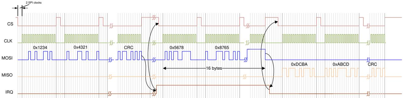
**Figure 7-9. SPI Communication**
