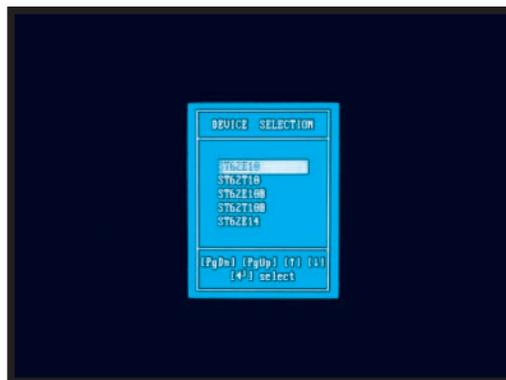
Fig.17 Come vedrete, sullo schermo apparirà una finestra con tutti i tipi di ST62. Con i tasti freccia cercate la sigla ST62E25 poi pigiate il tasto Enter.
